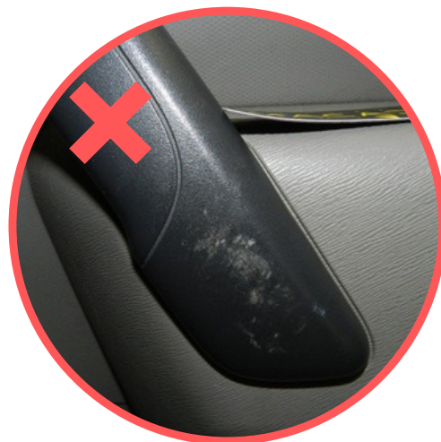
Diepe kras in een interieur deel.
