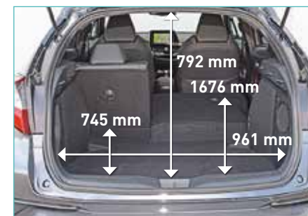
▲ De hoge tildrempel en de opstaande rand bij de neergeklapte achterbank zijn storend (C-HR).
